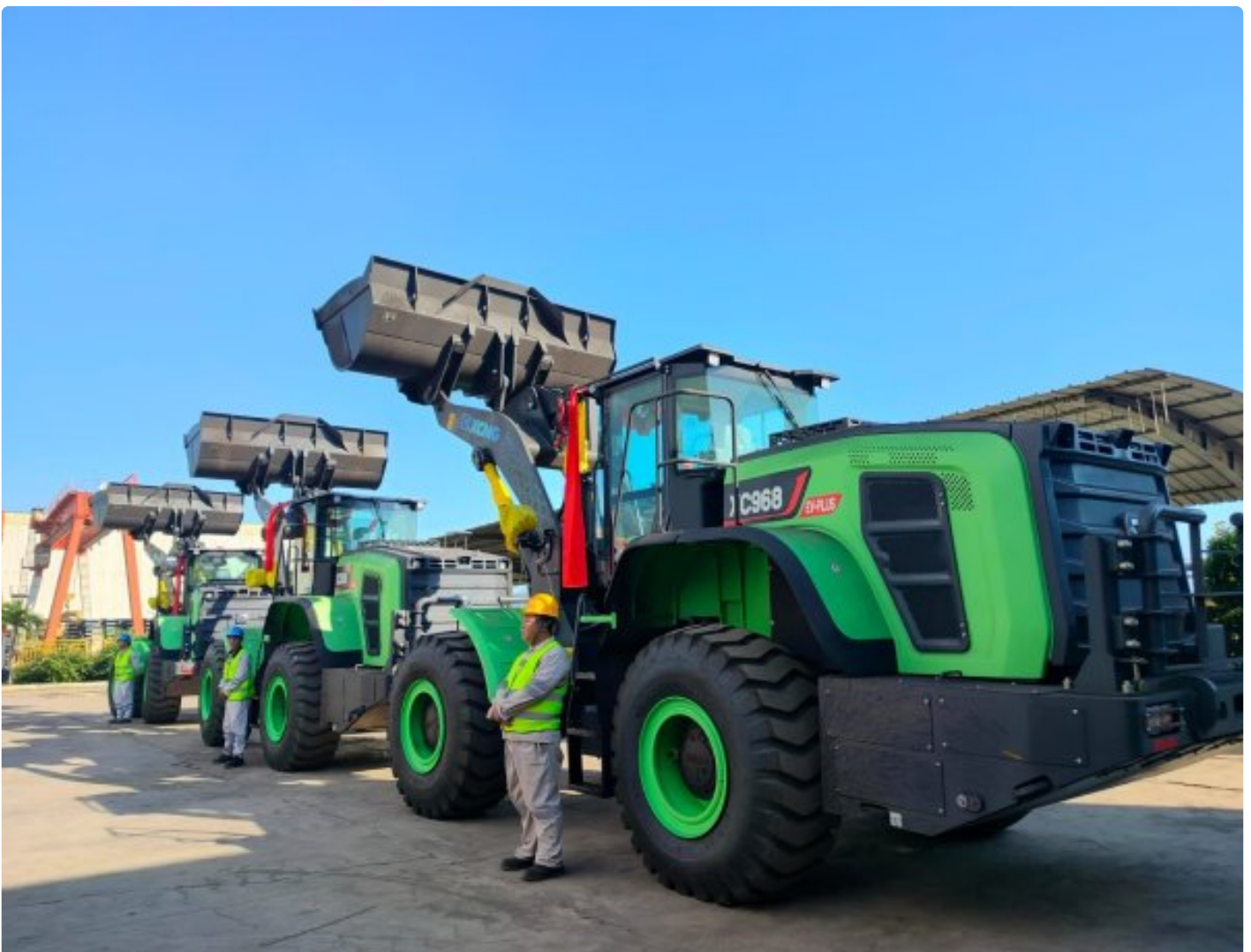
Loader Listrik Ramah Lingkungan milik PT IMIP
